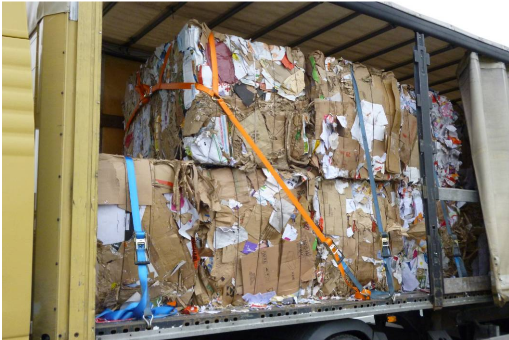
Bild 3: Altpapier einfach bzw. zweifach aufeinandergestellt
