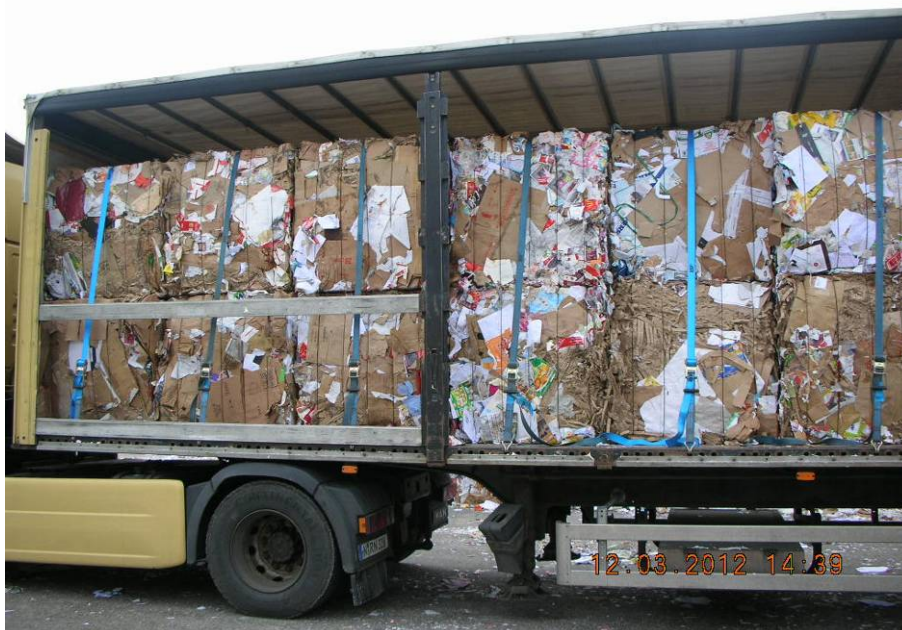
Bild 2: Formschlüssig gestellte Altpapierballen
