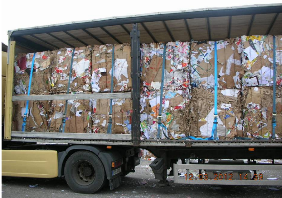
Bild 6: Gepresste Altpapierballen direkt an der Stirnwand
